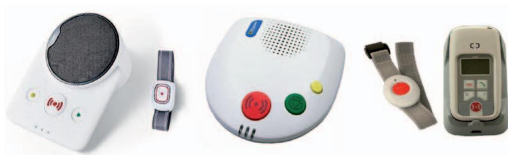
Bei Betätigung des Notrufknopfes am Handsender stellt die Basisstation automatisch eine Verbindung zur Rettungs- und Feuerwehrleitstelle (RFL) her, wo der ausgelöste Alarm sofort bearbeitet wird. In der RFL erscheinen auf einem Bildschirm sofort die Daten des Teilnehmers.
