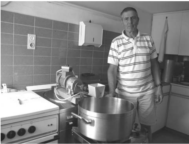
Josef Thurnher mit seinem „Käsknöpfler“ für bis zu 300 Personen (mit Zahnriemen und verlangsamttem Motor), 1970er-Jahre
