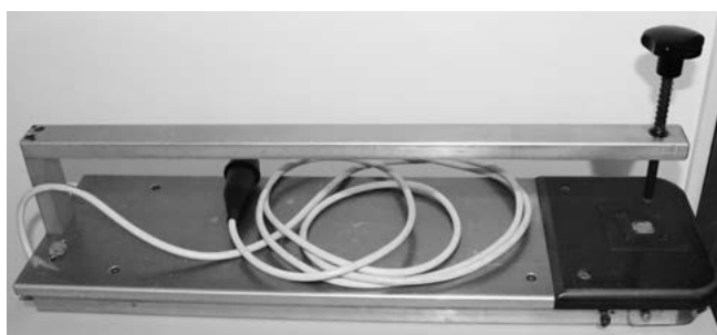
Mit der selbst konstruierten Maschine konnten Strasssteine effektiver auf Stoff appliziert werden. | Foto: Stadtmuseum Dornbirn
